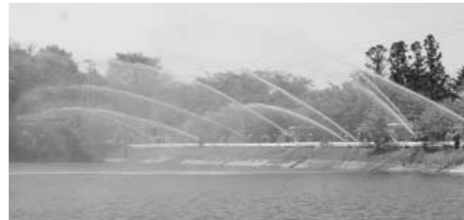
中村池での放水による点検
