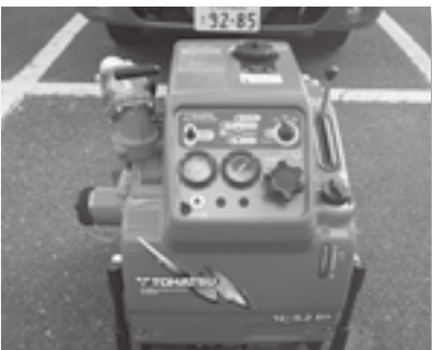
小型動力ポンプ
