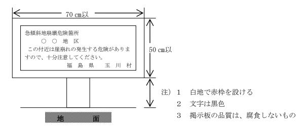
資料1-5-10 急傾斜地崩壊危険箇所標柱
