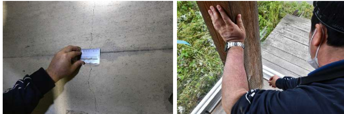
RC部のクラック計測
